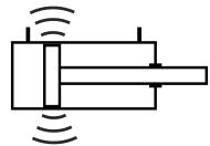
*Cilindro a corsa breve alesaggio 100 corsa 100- a doppio effetto Magnetico*
