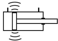
*Cilindro a corsa breve alesaggio 80 corsa 15- a doppio effetto Magnetico*
