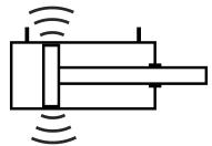
*Cilindro a corsa breve alesaggio 40 corsa 10- a doppio effetto Magnetico*
