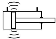
*Cilindro a corsa breve alesaggio 25 corsa 40- a doppio effetto Magnetico*
