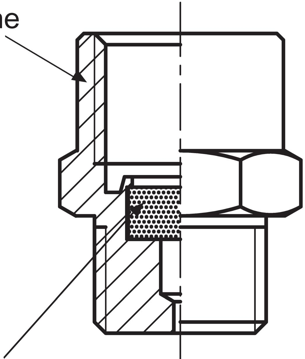
**Bronzo sinterizzato 8  $\mu\text{m}$** *Originale: 3369×3331 px (285.2×282.0 mm) | Mostrata: 189.0×186.9 mm | Ridimensionata: Si*
