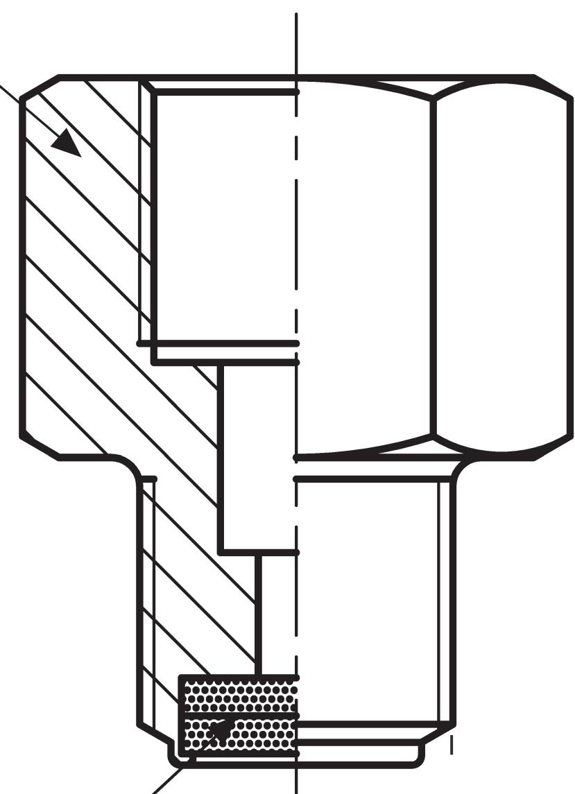
**Bronzo sinterizzato 8 µm***Originale: 3742x4330 px (316.8x366.6 mm) | Mostrata: 177.2x205.0 mm | Ridimensionata: Sì*
