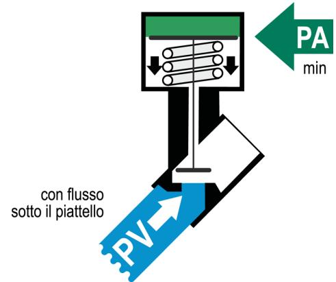
→ **PA** = Pressione Minima dell'attuatore per la chiusura della valvola
