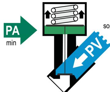
► PA = Pressione Minima dell'attuatore per l'apertura della valvola
