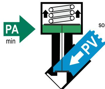
► PA = Pressione Minima dell'attuatore per l'apertura della valvola
