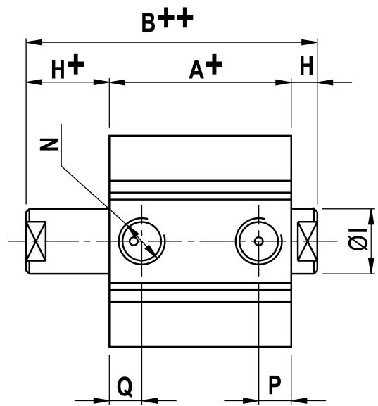
**+** = corsa - stroke      **++** = corsa (2x) - stroke (2x)
